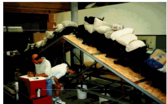
圖九、廠房屋頂結構物於實驗室中測試
